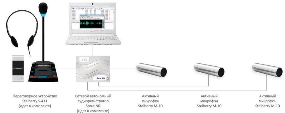
Аудиорегистратор Спрут NR имеет несколько аудиовходов. К ним могут быть подключены активные микрофоны STELBERRY в необходимом количестве. Кроме того, часть входов регистратора Спрут NR может быть использована для подключения систем «клиент-кассир». При подключении к телефонным линиям, Спрут NR может применяться, как эффективный регистратор телефонных разговоров.
