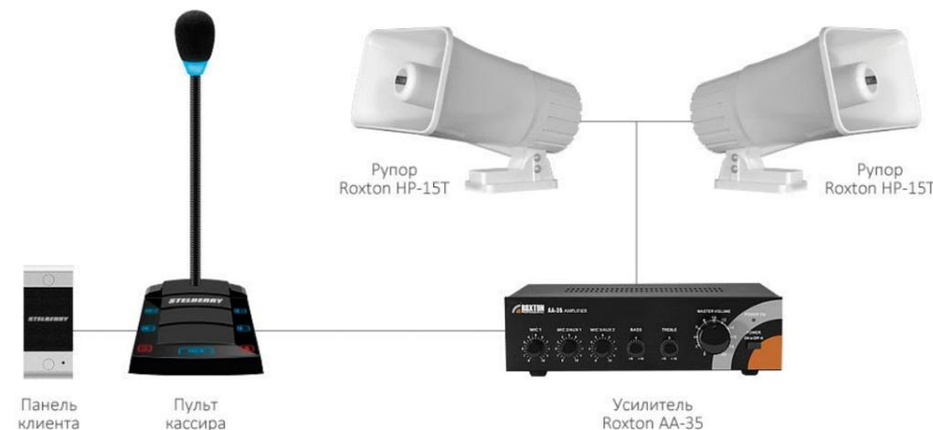
Подключив к пульту переговорного устройства STELBERRY S-520 из комплекта поставки решения усилитель с уличными рупорами, можно получить эффективную уличную систему речевого оповещения, идеально подходящую для любых типов автозаправочных станций.
