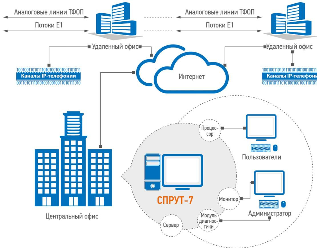
В результате пользователи и администраторы системы работают с системами записи разговоров в удаленных офисах как с единой системой, с общей базой данных. Такой подход значительно снижает общие издержки решения задачи записи телефонных раз-
