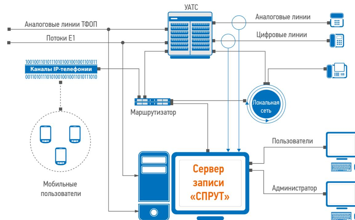
Внутренние и внешние телефонные линии, пользователи и администратор системы подключаются непосредственно к серверу «Спрут», имеющему все необходимые для этого встроенные интерфейсы. При записи только внешних линий, желательно подключение к серверу записи SMDR-порта АТС – это позволит системе записи автоматически определять внутреннего абонента, осуществляющего разговор по внешней линии, и сохранять информацию о нем в базе данных комплекса.
