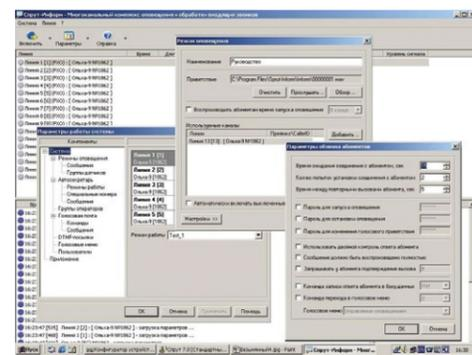
В системе оповещения «Спрут-Информ» реализованы специальные возможности обеспечения гарантированного получения сообщения получателем несколькими способами. В частности, для обнаружения факта ответа абонента при звонке через аналоговую линию используется алгоритм обнаружения голосовой активности (VAD), а также – детектирование переполюсовки. Всё это позволяет достоверно убедиться в ответе абонента без необходимости ожидания от него ввода специальных кодов подтверждения.
